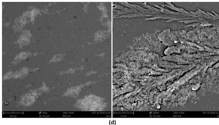
**Fig.4.** SEM images of samples grown at different conditions; (a)  $T= 30^{\circ}\text{C}$ ,  $t=75\text{min}$ , (b)  $T= 60^{\circ}\text{C}$ ,  $t=45\text{min}$ , (c)  $T= 60^{\circ}\text{C}$ ,  $t=75\text{min}$ , (d)  $T= 90^{\circ}\text{C}$ ,  $t=60\text{min}$ .
